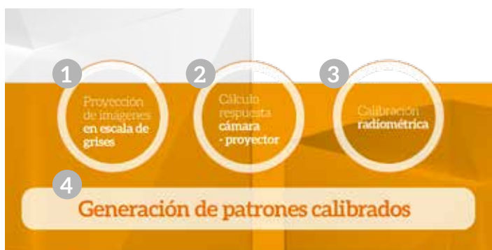
Gráfico 1. Reconstrucción tridimensional basada en la proyección digital de patrones
