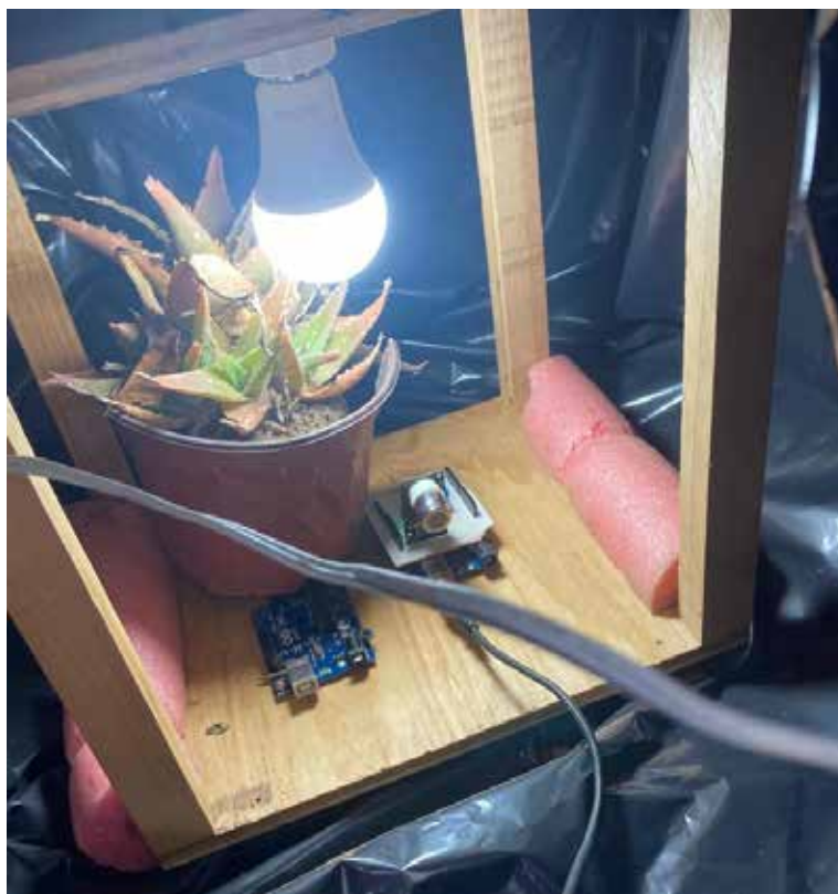
Figura 3. Sensor de gas dentro del invernadero
